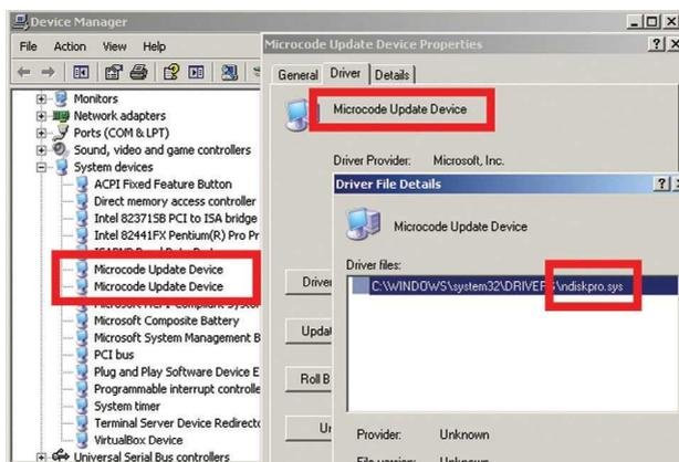
前述したように、キーロガーモジュールは収集したデータを暗号化してログファイルとして保存します。このときの暗号化アルゴリズムは、RC4と似ています。注目すべき点は、このモジュールがランダムに鍵を生成し、ログファイル名の中という予想外の場所にそれを格納することです。そのため、ファイル名のうち数字部分が擬似乱数を生成するための鍵データとして使用されます。異なるコンピューター上でも同じ結果が生成されるように、rand関数は静的にリンクされています。
